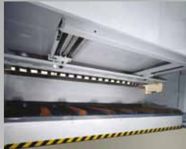
Registro posteriore a ricircolo di sfere da 1000 mm, velocità 230 mm/sec, ribaltabile a fine corsa. 1000 mm ball screw backgauge, speed 230 mm/sec and with lifting possibility at the end of stroke.
