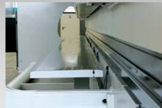
Supporto posteriore motorizzato corsa asse R 200 mm.
