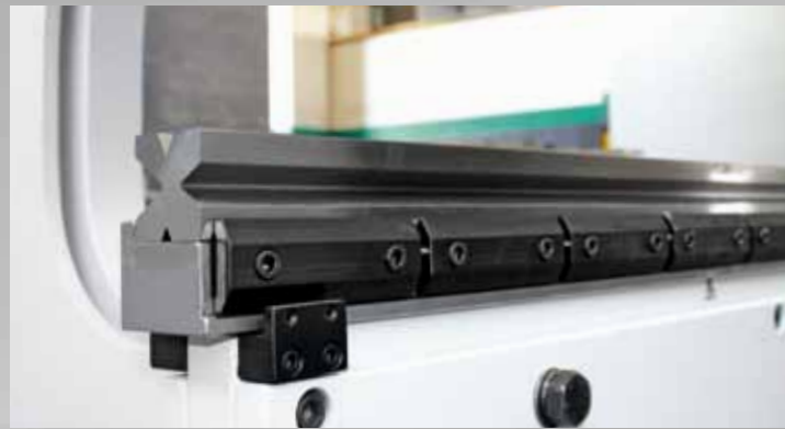
Bloccaggio matrice standard con staffe per utensili frazionati. Standard die clamping with clamps for multi-sectioned tools.
