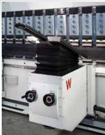
Accompagnatori lamiera anteriori che agevolano la lavorazione di lamiere di medie e grandi dimensioni. Sono gestiti dal CNC (A1-A2) e perfettamente sincronizzati con gli assi di piega (Y1-Y2). Regolabili manualmente in altezza e profondità in base alla matrice utilizzata.
