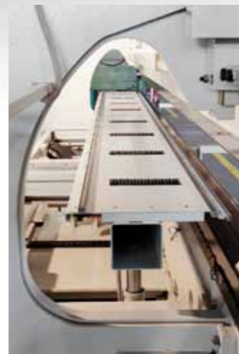
Particolare grande incavo da 750 mm. Particular of large gap of 750 mm.
