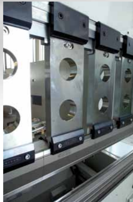
Intermedi con altezze maggiorate per esecuzione di profili scatolati in versione manuale o automatica. Intermediate clamps with extra heights to allow box shape profiles bending in manual or automatic mode.
