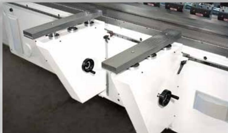
Supporti anteriori (tipo pesante) con regolazione verticale tramite volantino, scorrevoli su guide lineari. Consigliato per presse oltre 200 ton.
