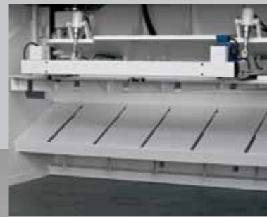
Sostegno pneumatico della lamiera in fase di scarico.
