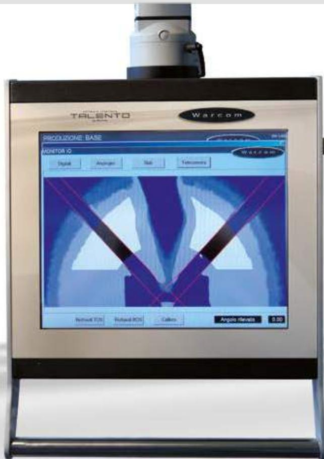
■ Il sistema BCS rileva il reale valore dell'angolo della piega in ogni istante durante la fase di piegatura. Questo permette al CNC di eseguire cicli di pressata con brevi risalite per scaricare il naturale ritorno elastico del materiale.
