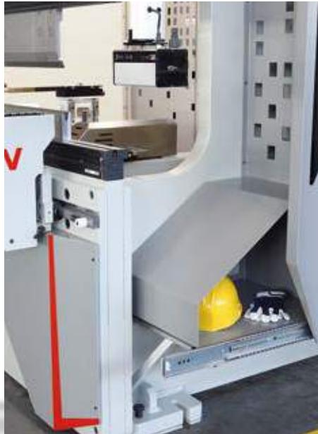
■ Lo spazio tra i ripari laterali e la struttura della macchina è stato utilizzato per ottenere un comodo vano portaoggetti adatto per posizionare vari strumenti di lavoro.
