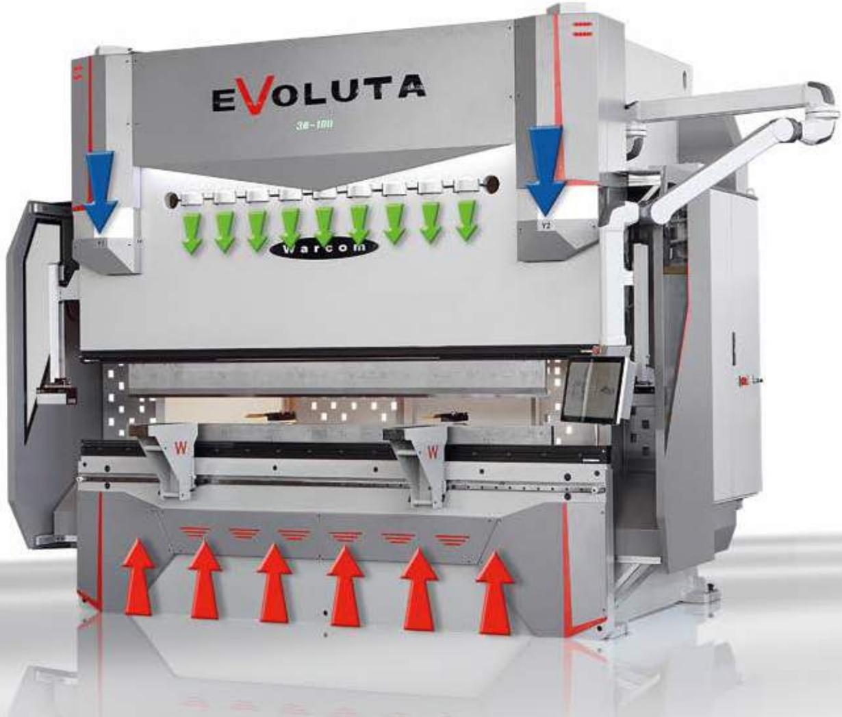
■ FCS è il nuovo e rivoluzionario sistema a doppia compensazione automatica in "real time" che garantisce il risultato di una perfetta piega con qualsiasi tipologia di materiale e tipo di laminazione/taglio dello stesso.
