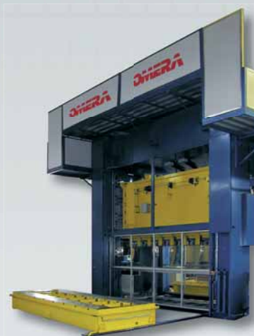
Pressa meccanica composita a doppio montante da 800 tonnellate con tavola 4200 x 1600
